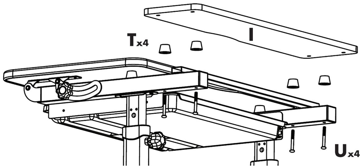
Установите стеллаж в сборе на столешницу с помощью саморезов 4x25.
