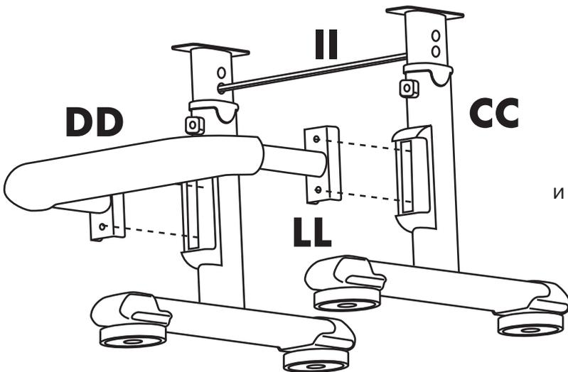
Выкрутите предустановленные винты 6x9 на обеих ножках стула, установите шестигранный вал в подъемные отверстия левой и правой ножки, а затем установите подставку для ног (с помощью предварительно выкрученных предустановленных винтов).
