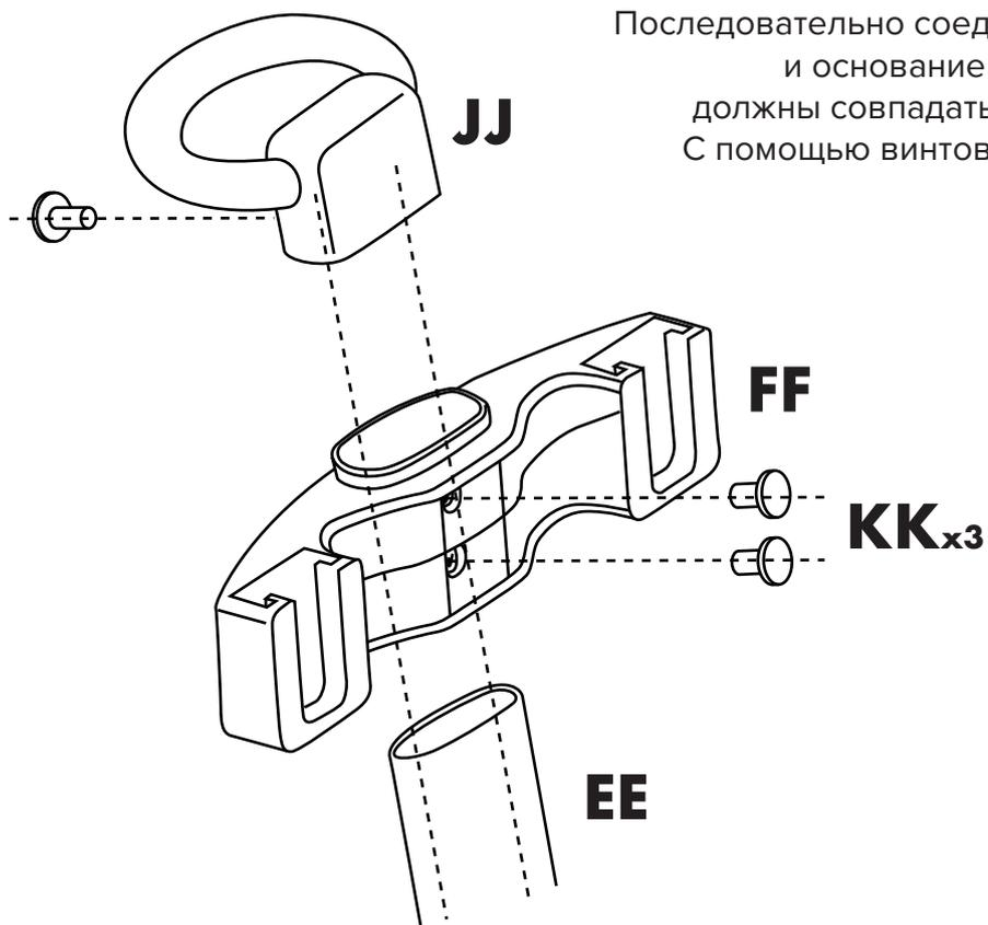
Последовательно соедините ручку стула, кронштейн и основание стула. Отверстия кронштейна должны совпадать с отверстиями на основании. С помощью винтов 6x14 закрепите конструкцию.
